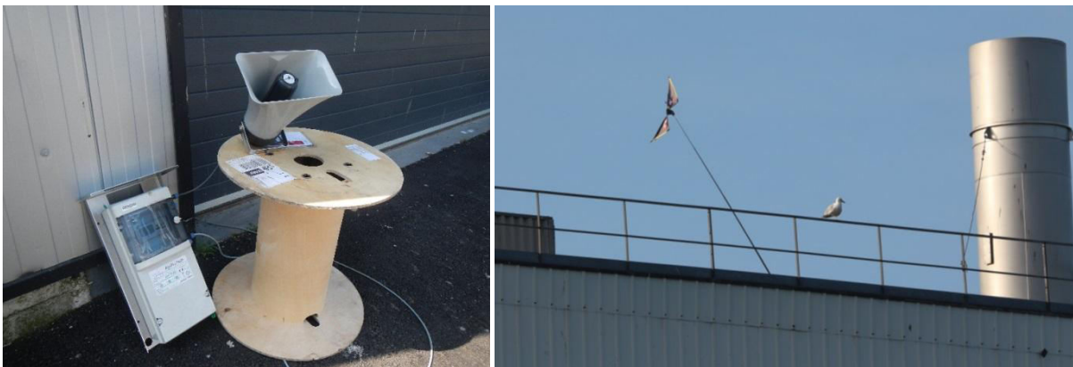
Figure 13 : Appareil sonore d'effarouchement installé sur l'entreprise ANIRI France (à gauche) et épouvantail (à droite) – Photos TBM environnement
